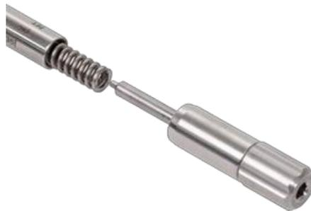
A montagem da chave será concluída quando o conjunto mola/punção (6) for inserido no cabo (4) e o botão de ajuste (7) for aparafusado neste último.
