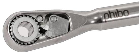
Lubrificare moderatamente la zona di contatto tra i denti dell'ingranaggio (1) e il punto di rotazione del cricchetto (2) come mostrato in figura 6.
