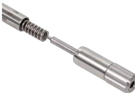
Il montaggio del Cricchetto è completato quando il gruppo molla/punzone (6) viene inserito nell'impugnatura (4) e la manopola di regolazione (7) viene avvitata in quest'ultima.
