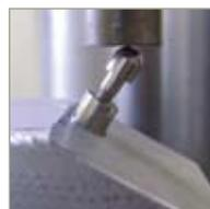
Ensayo mecánico de vida fatiga. Máquina de ensayo (alta frecuencia).
